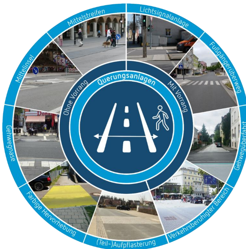
Abbildung 9: Unterschiedliche Querungsanlagen für zu Fuß Gehende
