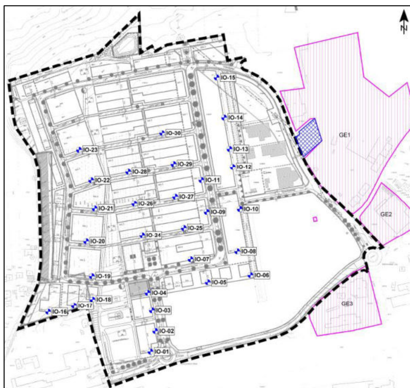
Abbildung 4 - Schallquellen Gewerbe außerhalb des Plangebiets
